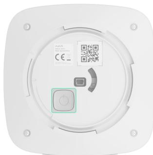
Per avviare il processo di rilevamento e abbinamento, la sirena deve essere localizzata all'interno dell'area di copertura della rete wireless dell'hub (in un unico locale protetto). Se il dispositivo era già stato assegnato a un altro hub, spegnere HomeSiren e avviare la procedura standard per aggiungere il dispositivo.
